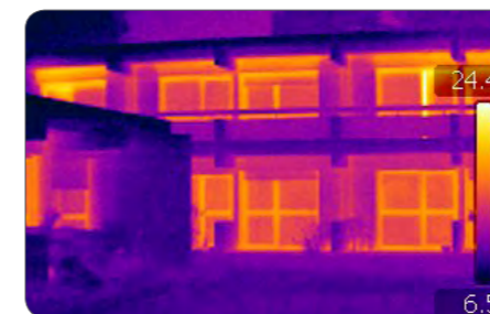
Thermographie infrarouge permettant de visualiser la performance de la construction
